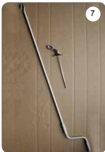
Korba, przegub Cardana 45° lub 90° z uchem [7].
