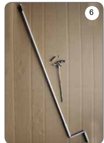
Korba, przegub Cardana 45° lub 90° z zaczepem dzwonicowym [6].
